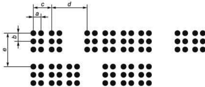
**Рисунок 2 - Схема размеров рельефно-точечного шрифта Брайля.**
