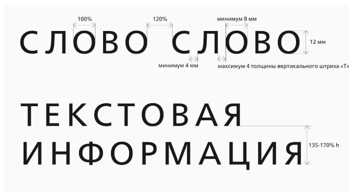
Рисунок 4 - Параметры шрифтовых знаков и рельефа (рифа) РЛШ
