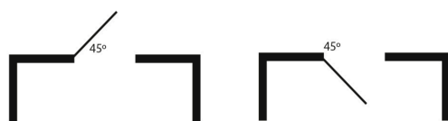
Рисунок 32 - Наружное и внутреннее открывание одностворчатой двери
