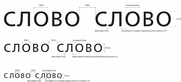
Рисунок 6 - Изменение плотности набора в зависимости от размера РЛШ для высоты 12 мм, 20 мм, 27 мм
